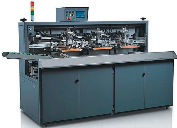
Machine pour imprimer des bouteilles, LC Printing Machine Factory Limited. Cette machine imprime en direct 900 pièces par heures en trois couleurs.
